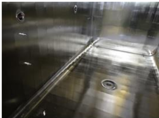
Εικόνα 4 : Ανοξείδωτος θάλαμος αποστείρωσης (autoclave) πριν από (Άνω φωτ.) και μετά από de-rouging (Κάτω φωτ.) χρησιμοποιώντας τις υπηρεσίες Steri-Protect της HENKEL Beiz.
